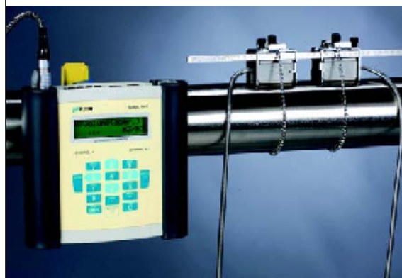
Измерване с преобразователи монтирани с прикрепващи кутии и разходомер фиксиран към тръбата с QuickFix тръба
